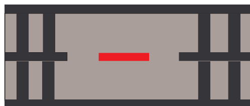
FIG. 1.4.21 – Section d’une ligne de transmission triplaque
