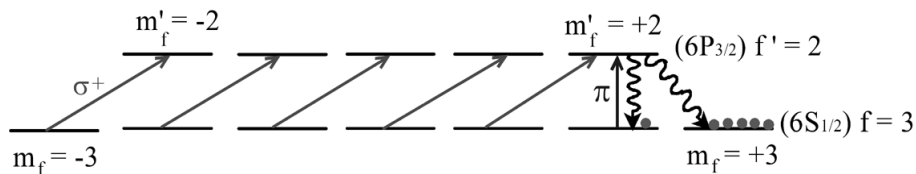
FIG. 2.14 – Processus de pompage optique vers l'état |f = 3, m_f = +3\rangle . La lumière polarisée \sigma^+ permet d'accumuler les atomes dans les états |f = 3, m_f = +2, +3\rangle . Un second faisceau laser polarisé \pi permet de ramener les atomes de l'état |f = 3, m_f = +2\rangle vers |f = 3, m_f = +3\rangle .
