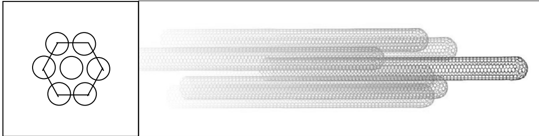
Figure 8: Représentation schématique d'un faisceau de nanotubes - Schéma de gauche: réseau hexagonal résultant d'une coupe transversale.
