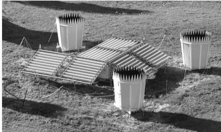
FIG. A.3: Le radar UHF PCL1300 lors des essais en bistatique (7 au 22 novembre 2002). Trois paires d'antennes ont été installées afin que chacune d'elles ait la même direction de visée. Ce dispositif permet alors au radar de fonctionner alternativement en bistatique et en monostatique avec 3 faisceaux.
