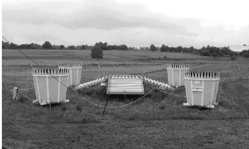
FIG. 3.1: Le profileur de vent UHF PCL1300 avec son système RASS (Radio Acoustic Sound System), qui permet de mesurer la température virtuelle de l'air.
