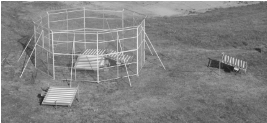
FIG. A.4: Le radar UHF PCL1300 et son dispositif expérimental lors de la campagne de mesures du 5 août au 10 novembre 2003. Deux antennes obliques du radar ont été déportées pour qu'elles tirent dans la même direction que celles restées à côté de l'antenne verticale. L'enceinte grillagée de 2,5 et 5 m de haut est disposée autour du radar. Les tirs sont effectués séquentiellement pour chaque antenne, afin de permettre au radar de réaliser des mesures à 3 faisceaux avec et sans enceinte grillagée dans les mêmes conditions météorologiques.
