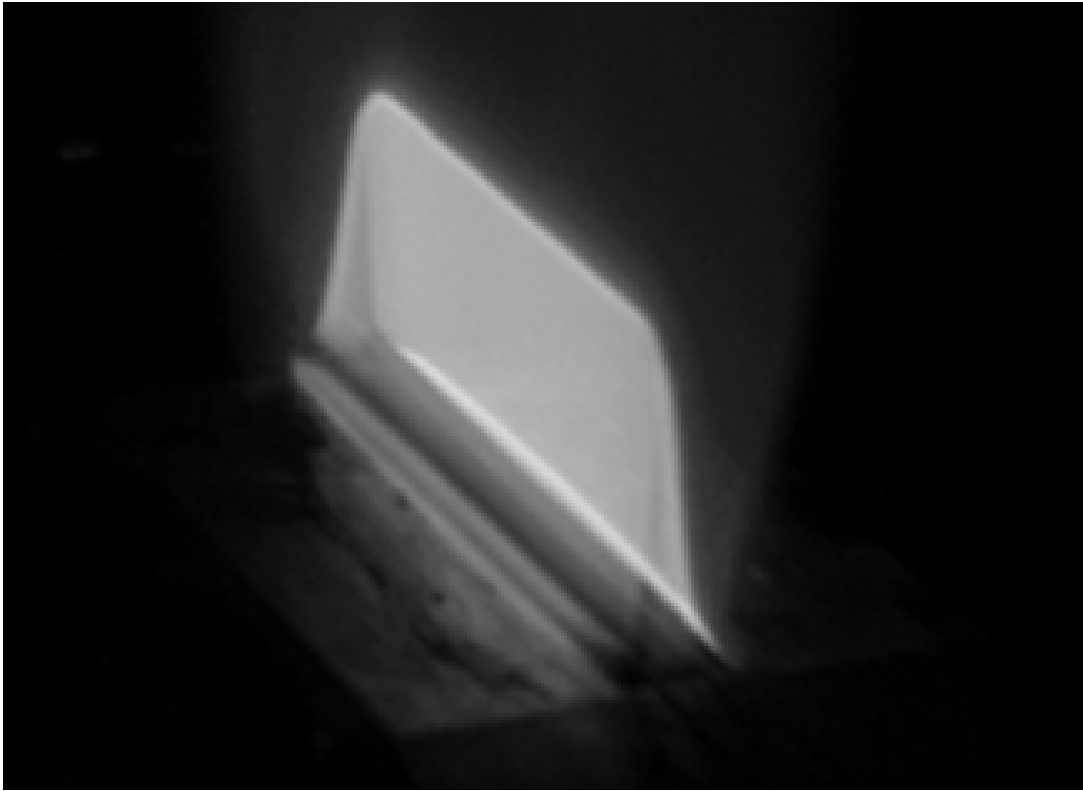
FIG. 3.12 – Vue de 3/4 de la flamme diédrique accrochée en sortie du brûleur à fente. La ligne noire à la base de la flamme représente le barreau qui sert d'accroche-flamme et d'excitateur.
