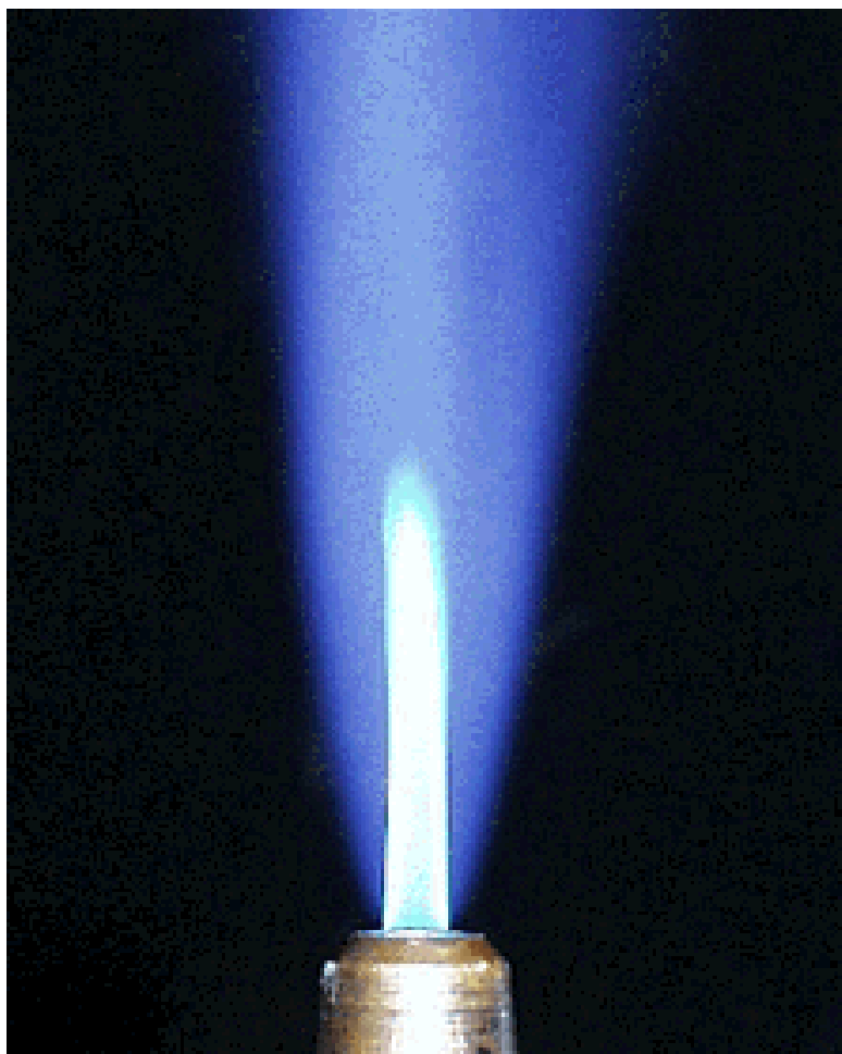
FIG. 1.4 – Photographie de la flamme propane-oxygène étudiée au cours de cette étude (chalumeau « Varial-G2 », richesse \phi = 1,33 et débit Q = 30 l/min).
