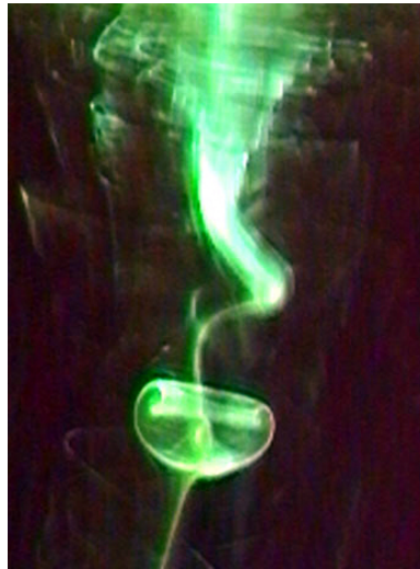
FIG. 7.6 – Visualisation de l'éclatement tourbillonnaire qui apparaît en présence d'un fort écoulement axial sur un tourbillon solitaire.
