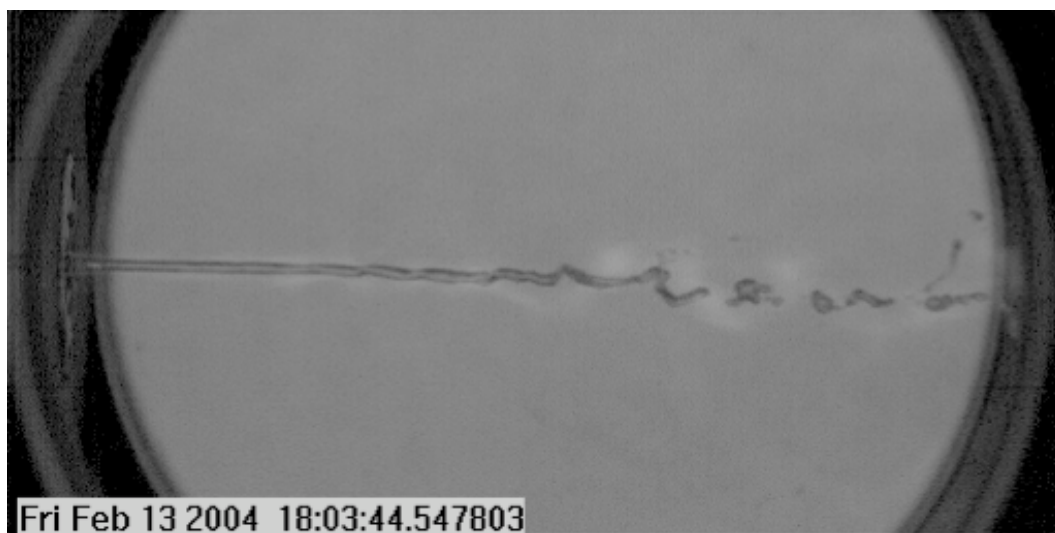
FIG. 4.5 – (Non)-atomisation avec une flamme accrochée, P = 4.7 bar. Le rapport de quantité de mouvement calculé ( J = 1.5 ) et le nombre de Weber ( \approx 160 ) sont comparables à ceux de la figure 4.2.
