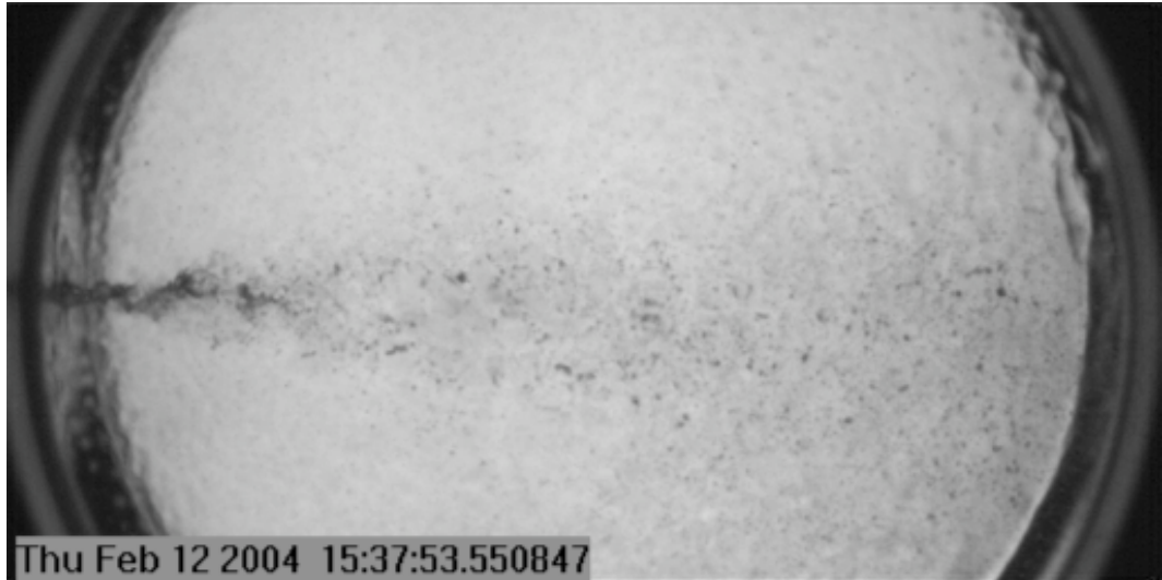
FIG. 4.1 – Atomisation à froid, P_{CRC} = 7 bar, J = 7
