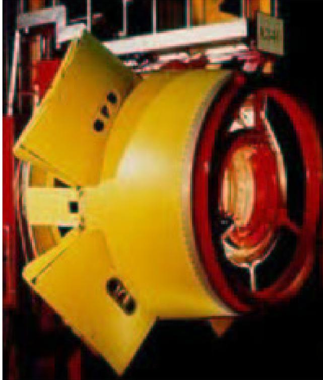
FIG. 2 – *Inverseur de poussée à portes Hispano-Suiza Aérostructures.*
