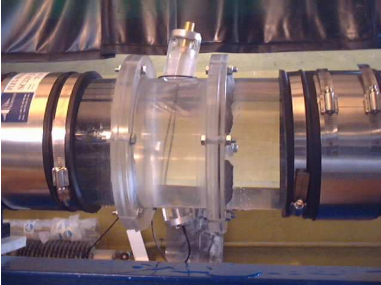
FIG. 9.4 – Transducteur monté sur une conduite de 20 cm de diamètre. Écoulement d'eau claire à surface libre. Le transducteur est placé sous la conduite.
