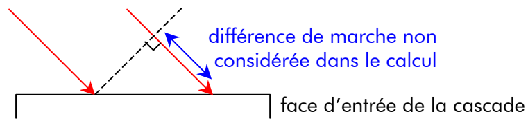
Figure V-39 - Illustration de différence de marche non considérée dans le calcul, introduite en amont de la cascade par un tilt
