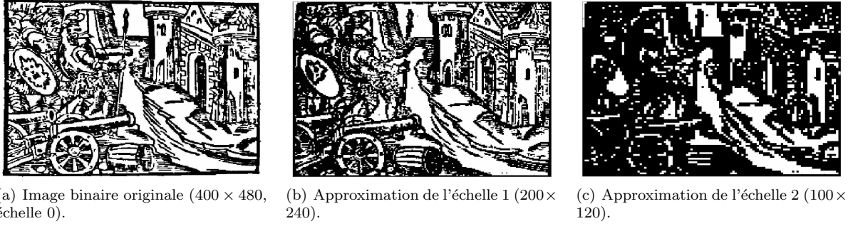
FIG. 2.8 – Image initiale et ses approximations aux échelles 1 et 2 par le filtre de Haar morphologique. Les approximations sont de plus en plus sombres. Ce qui est dommageable pour la conservation des structures de l'image.
