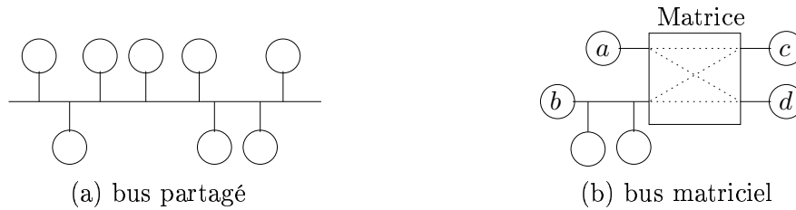
FIG. 2.3 – Topologies partagées et matricielles des bus
