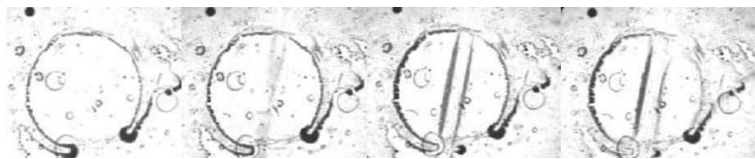
FIG. 12.2: Expérience macroscopique huile dans eau sur parylène, dans le dispositif expérimental de création de défauts. Plutôt que de démouiller en rentrant des oreilles, le film semble s'amincir au-dessus du défaut linéaire lorsque la tension augmente (de gauche à droite).
