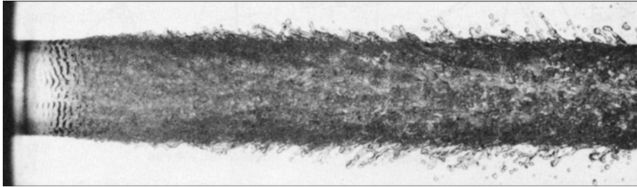
FIG. 1.2: Jet d'eau de 6 mm de diamètre se déplaçant à la vitesse de 25 m/s dans de l'air initialement au repos, d'après Hoyt et Taylor [40].
