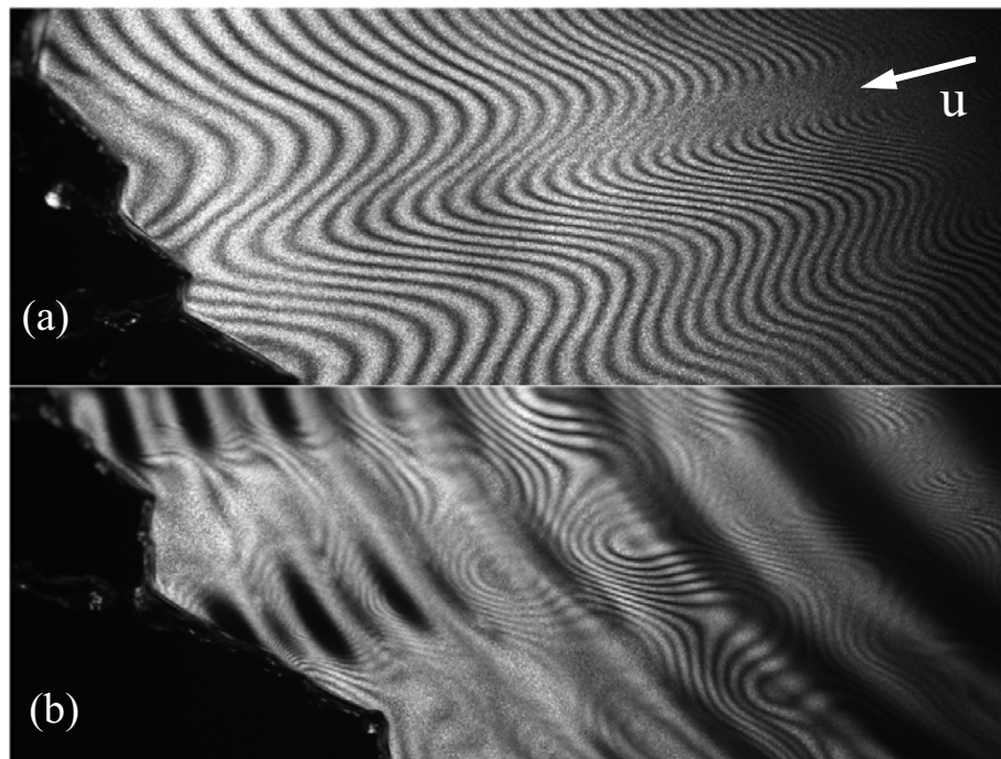
FIG. 4.1: Visualisation par interférométrie laser du champ d'épaisseur de la nappe axisymétrique dans le régime stable : (a) cas libre, (b) avec oscillations du cylindre d'impact. La zone de la nappe photographiée est la même sur chaque image.
