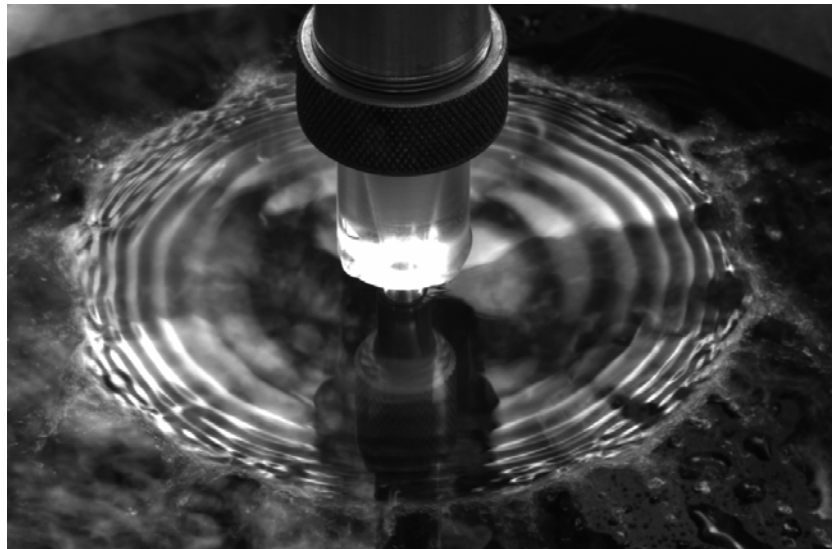
FIG. 3.3: Réseau d'ondes stationnaires observé sur la nappe vibrée pour un temps de pose équivalent à une observation à l'œil nu (1/30 s).
