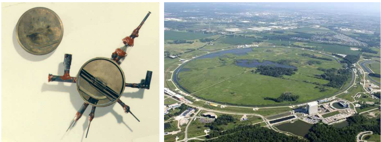
FIG. 1 – A gauche, image du premier cyclotron de 11.4 cm construit en 1931 par Lawrence et Livingston. A droite, photo aérienne du Tevatron de 2 km de diamètre, construit en 1982.
