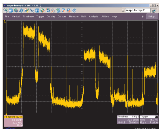
FIG. 6.22 : Capture Fréquentielle du signal MC-CDMA en seconde fréquence intermédiaire, l'échelle fréquentielle étant de 20\text{ MHz/div}
