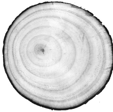
Figure 2.13. Exemple de coupe transversale d'un arbre déformé (Forest et al. , 2004).
