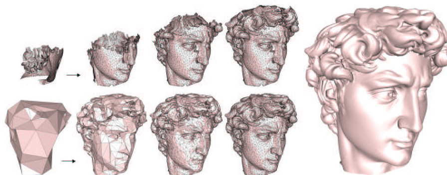
FIG. 1.5 – Etape intermédiaire de reconstruction selon une méthode monorésolution (en haut) ou une méthode progressive (en bas). Image extraite de [11].
