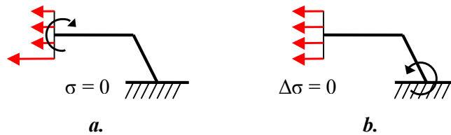
Figure 5 : Schéma des moments mis en jeu a. avec gradient de contrainte et b. sans gradient de contrainte.
