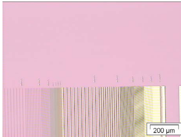
Figure V.2 : Image en microscopie optique d'un substrat avec des cuvettes de \text{SiO}_2/\text{Si} orientées \langle 110 \rangle de 180 nm de profondeur
