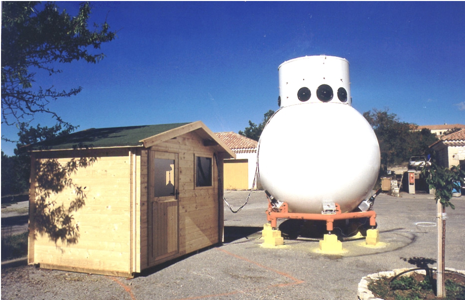
Figure 67 : Le télescope-boule OVLA installé à l'OHP à côté de sa « station de pilotage ».
