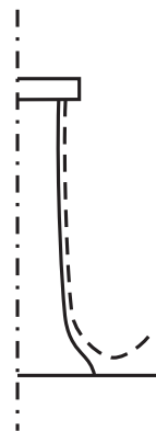
FIG. 9.8 – Représentation schématique du profil obtenu avec un faisceau de particules oblique.
