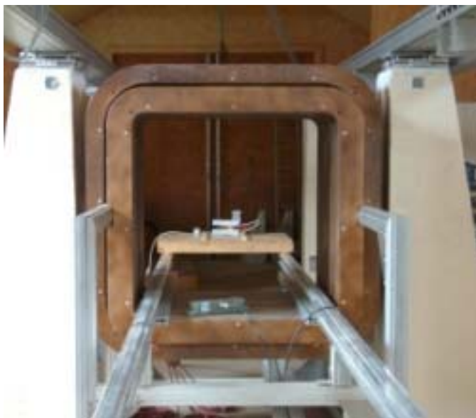
Figure 4.27 : Four permettant le traitement magnétique d'objets quelconques
