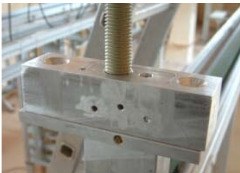
Figure 4.23 : Système mécanique permettant de déplacer la structure interne
