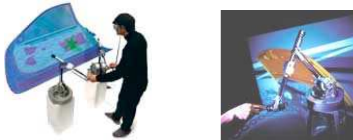
Figure 1.6. Exemple d'assemblage virtuel par interaction avec des objets virtuels : montage virtuel avec un dispositif à retour d'efforts [LIST CEA 2003].
