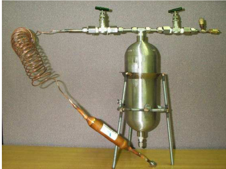
Figure 4.6 : Dispositif expérimental pour mesurer la teneur en huile
