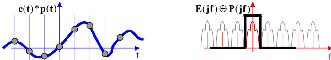
FIG. III.14.: Reconstitution du signal analogique à partir du spectre du signal échantillonné en appliquant un filtre de gain 1
