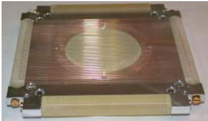
FIG. III.5.: Photographie du mDLA, montrant l'écran phosphore au centre des lignes à retard
