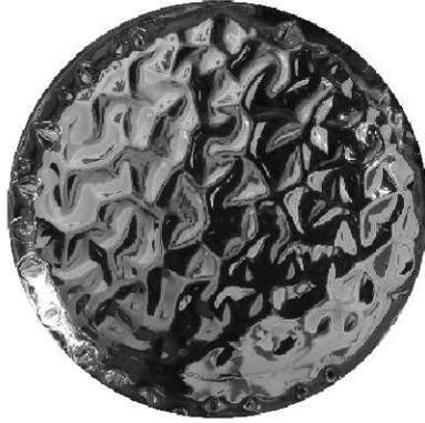
FIG. 1.2 – Vue de dessus de la surface supérieure d'un gel en expansion dans un bécher (géométrie cylindrique). Photo T. Mora [74]. On remarquera que (presque toutes) les crêtes se rejoignent par groupe de trois. Ces structures peuvent être proches de motifs quasi-hexagonaux déjà observés avec certains gels [59].
