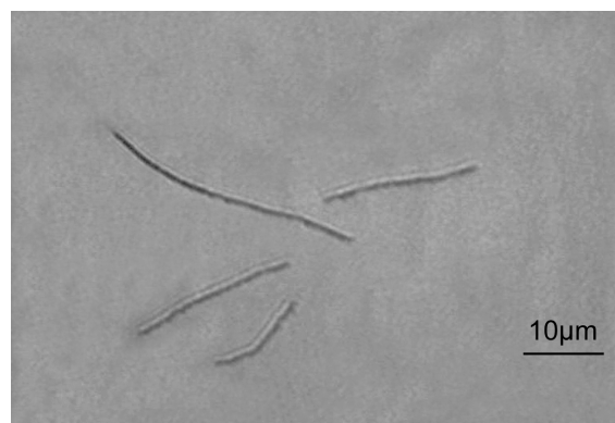
Figure 72 : chaînes permanentes, le champ est supprimé, mais les particules ne se redispersent pas.
