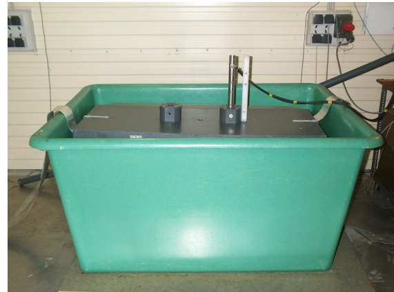
Figure II-10 : Photographie de l'ensemble cuves d'essais - électrodes de décharge
