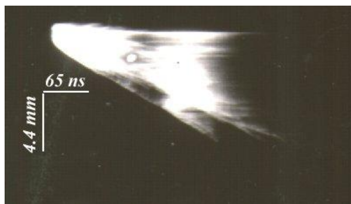
Figure III-30: (b) Convertisseur d'images en mode streak d'une décharge électrique supersonique dans l'eau correspondant à la figure III-30 (a) (polarité positive, U_m = 44\text{kV} , R_p = 150\mu\text{m} , balayage = 400ns)
