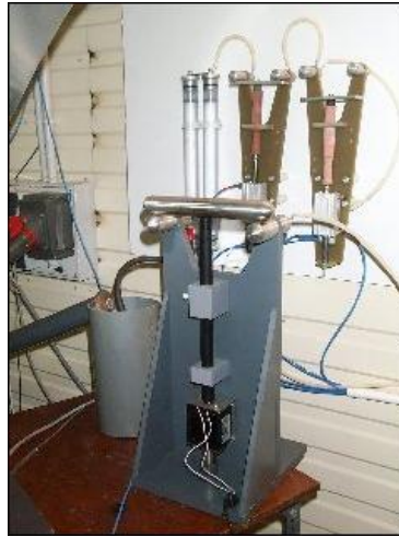
Figure 11-18 : Système de sécurité (dump) électrique
