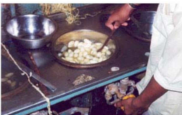
3.2.2 : ébullantage des cocons pour décoller l'extrémité du fil de soie. Siddalaghata, Octobre 2002, C. Didelon
