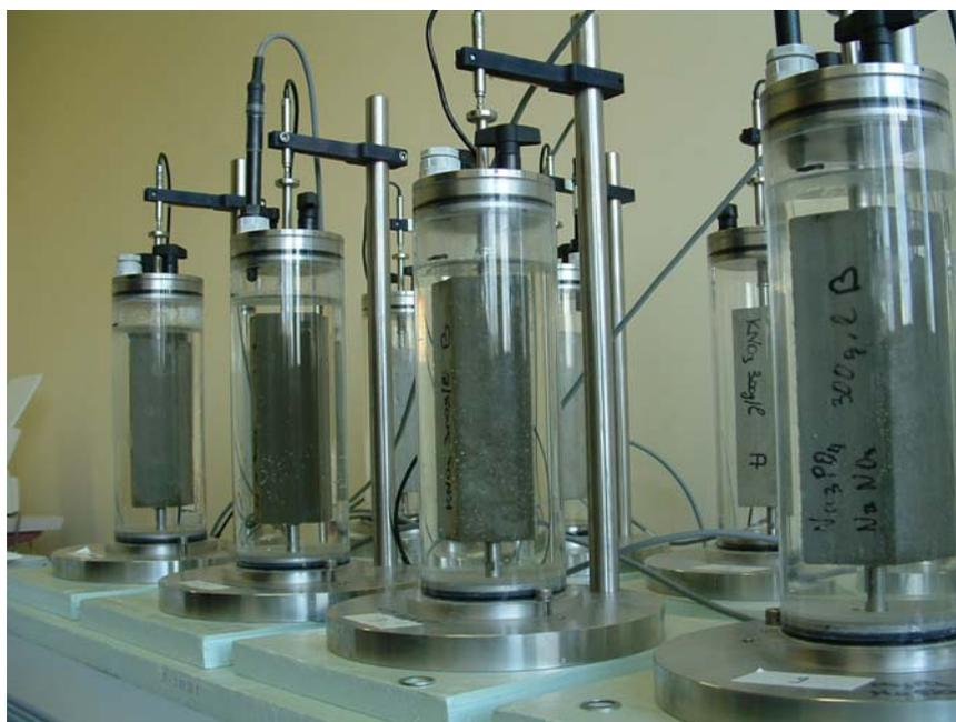
**Figure 72 : Photographie représentant le dispositif de suivi des dimensions en continu d'éprouvettes de mortiers.**
