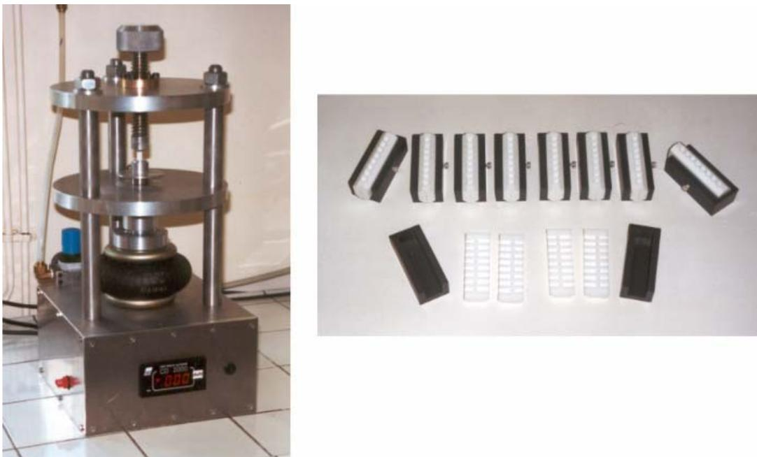
**Figure 64 :** Photographies de la presse utilisée pour mesurer les résistances en compression des éprouvettes des pâtes et mortiers de ciment (à gauche) et des moules en téflon utilisés pour fabriquer ces mêmes éprouvettes (à droite).
