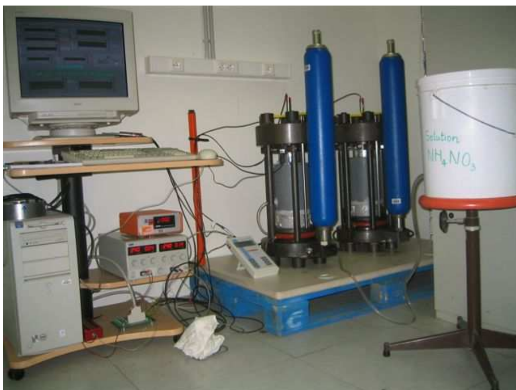
FIG. 2.68. Photo du dispositif des essais de fluage sous solution de nitrate d'ammonium à 6M, et dans l'eau.
