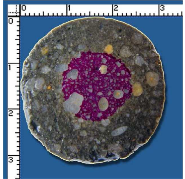
FIG. 2.24. Profil de concentration de calcium dans une éprouvette en mortier après 18 jours de lixiviation sous solution de NH_4NO_3 6M.
