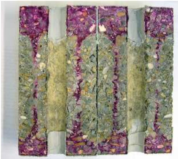
FIG. 3.25. Épaisseurs dégradées différentes entre l'intérieur et l'extérieur d'une éprouvette creuse
