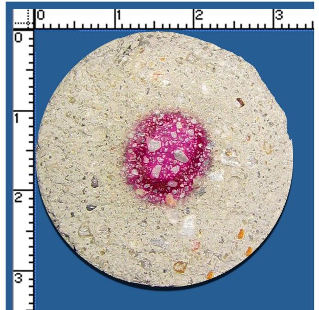
FIG. 2.26. Profil de concentration de calcium dans une éprouvette en mortier après 29 jours de lixiviation sous solution de NH_4NO_3 6M.
