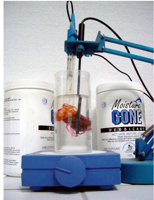
FIG. 2.7. Montage de l'essai de test de stabilité du granulats par rapport à la solution NH_4NO_3
