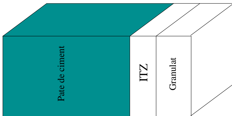
FIG. 1.14. Modèle multi-échelle pour tenir en compte l'effet des auréoles de transition
