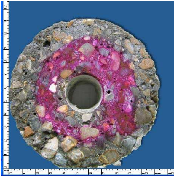
FIG. 2.36. Profil de concentration de calcium dans une éprouvette cylindrique creuse après 105 jours de lixiviation sous solution de NH_4NO_3 6M.
