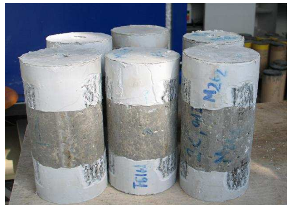
FIG. 2.4. Éprouvettes cylindriques recouvertes de résine de silicone
