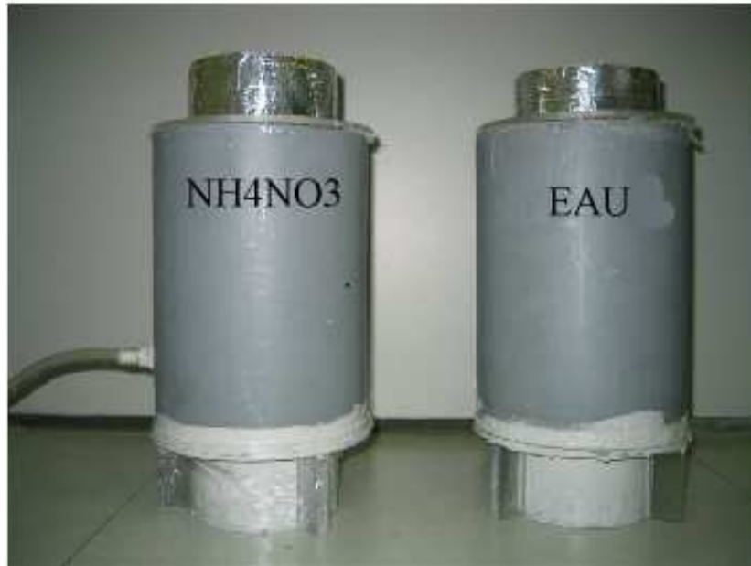
FIG. 2.67. Eprouvettes en béton pour les essais de fluage. A gauche sous solution de nitrate d'ammonium, et à droite dans l'eau (essai témoin) .
