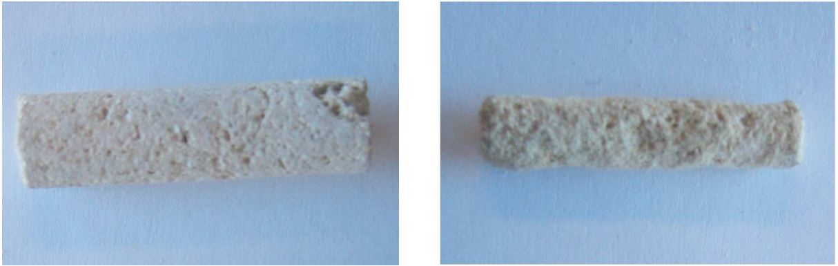
FIG. 2.10. Photos de l'échantillon à l'état sain et après 142 jours de dégradation dans la solution de NH_4NO_3
