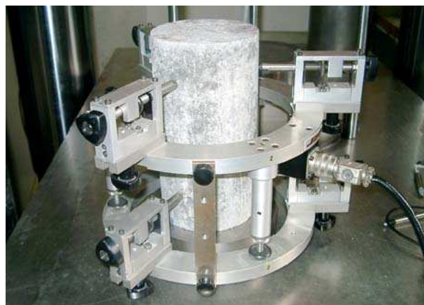
FIG. 2.48. Extensomètres utilisés pour la mesure des déformations.
