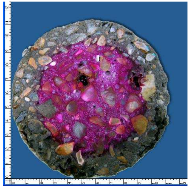
FIG. 2.37. Profil de concentration de calcium dans une éprouvette cylindrique pleine après 105 jours de lixiviation sous solution de NH_4NO_3 6M.
