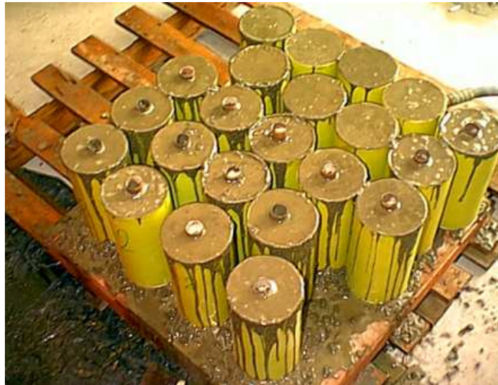
FIG. 2.2. Coulage des éprouvettes en béton
