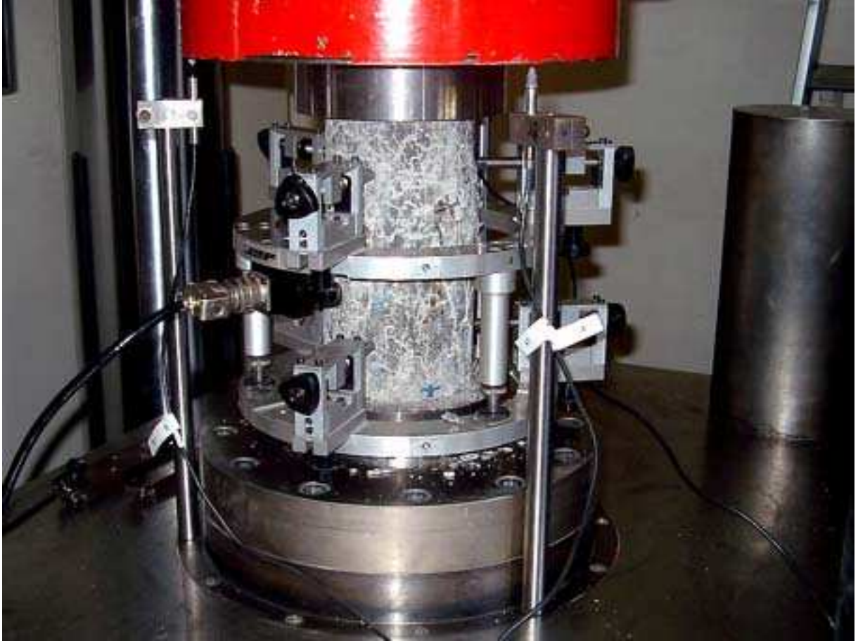
FIG. 2.50. Montage de l'éprouvette dans la presse et dispositif des capteurs et de l'extensomètre pour l'essai de compression du béton
