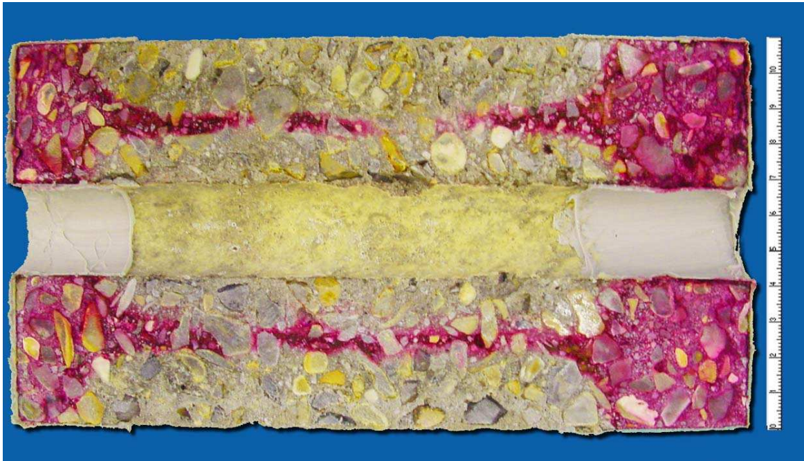
FIG. 2.44. Profil de concentration de calcium dans une éprouvette creuse après 163 jours de lixiviation sous solution de \text{NH}_4\text{NO}_3 6M.
