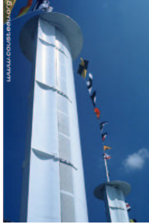
FIGURE 4.8 – Turbovoile conçue par l'équipe du commandant Cousteau
