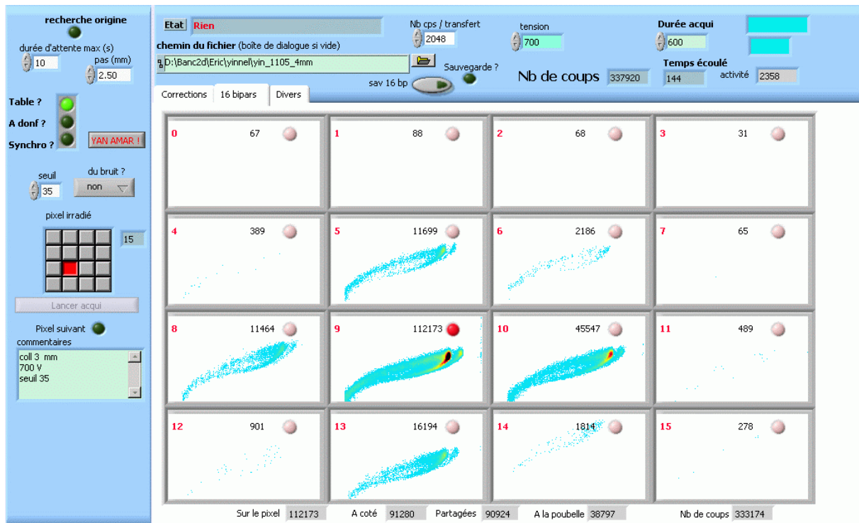
Figure 72 : Acquisition sous LabView. Visualisation des 16 spectres bi-paramétriques temps anode vs amplitude anode pour chacune des 16 anodes. Le collimateur est situé au-dessus de la voie 9 (schématisé par le disque rouge).
