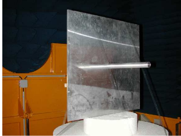
FIG. 3.11 – Photo du montage du cylindre fin pour l'expérimentation
