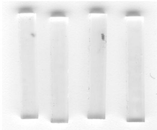
Figure III.4 : Poutres en  $\text{GaPO}_4$  réalisées par usinage ultra sonore dans une plaque Z.
