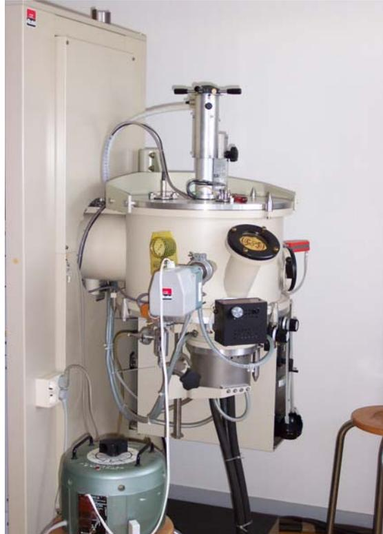
Figure III.13b : Photo du dispositif d'évaporation sous vide.
