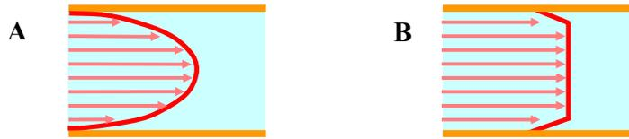
**Figure 3 : Profil des écoulements** A) Poiseuille B) électroosmotique
