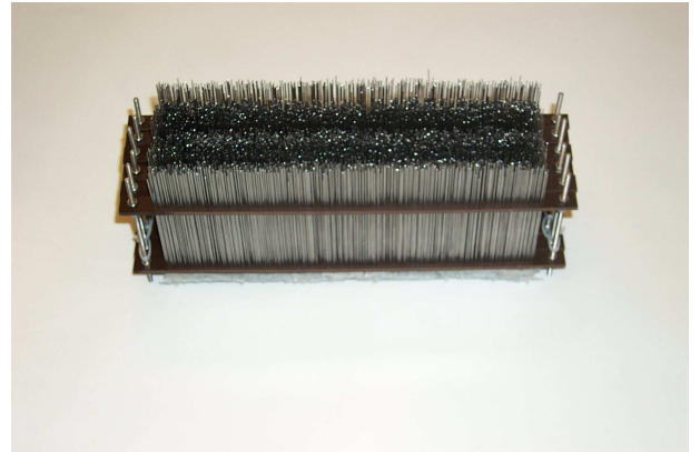
FIG. 1.24: Un échantillon de tiges de 80 mm d'épaisseur formé par la juxtaposition de tranches de la figure 1.23.
