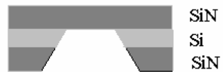
Fig. 2.4 Schéma d'une grille SiN utilisée pour visualiser les fils de Co en TEM
