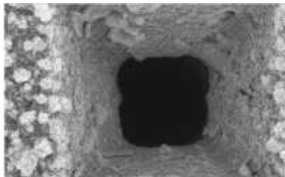
FIG. 2.4: Pore avec dépôt de catalyseur de Neah Power Systems.
