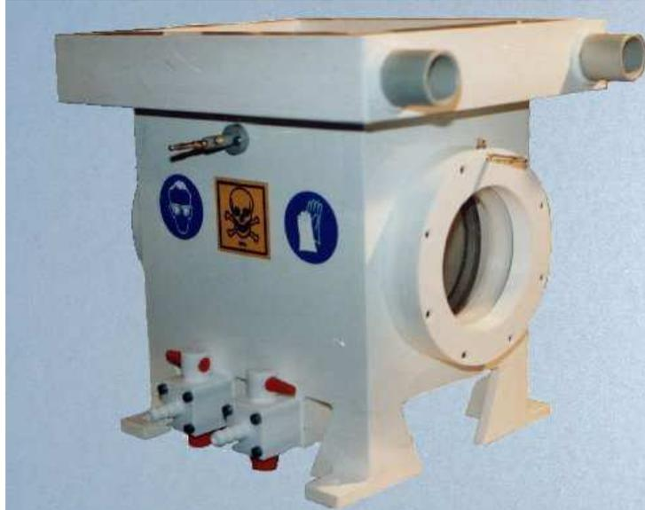
FIG. 3.8: Machine de gravure HF du silicium par AMMT.
