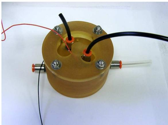
FIG. 6.1: Première cellule de test réalisée en résine par stéréolithographie par Sagem.
