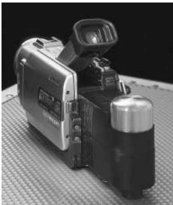
FIG. 2.7: Prototype de pile pour camscope développé par le Fraunhofer Institute for Solar Energy Systems.
