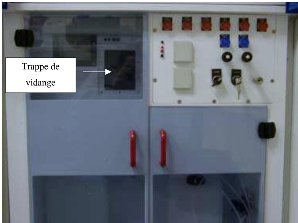
*Figure 3* : vue du panneau avant du stand d'acidage
