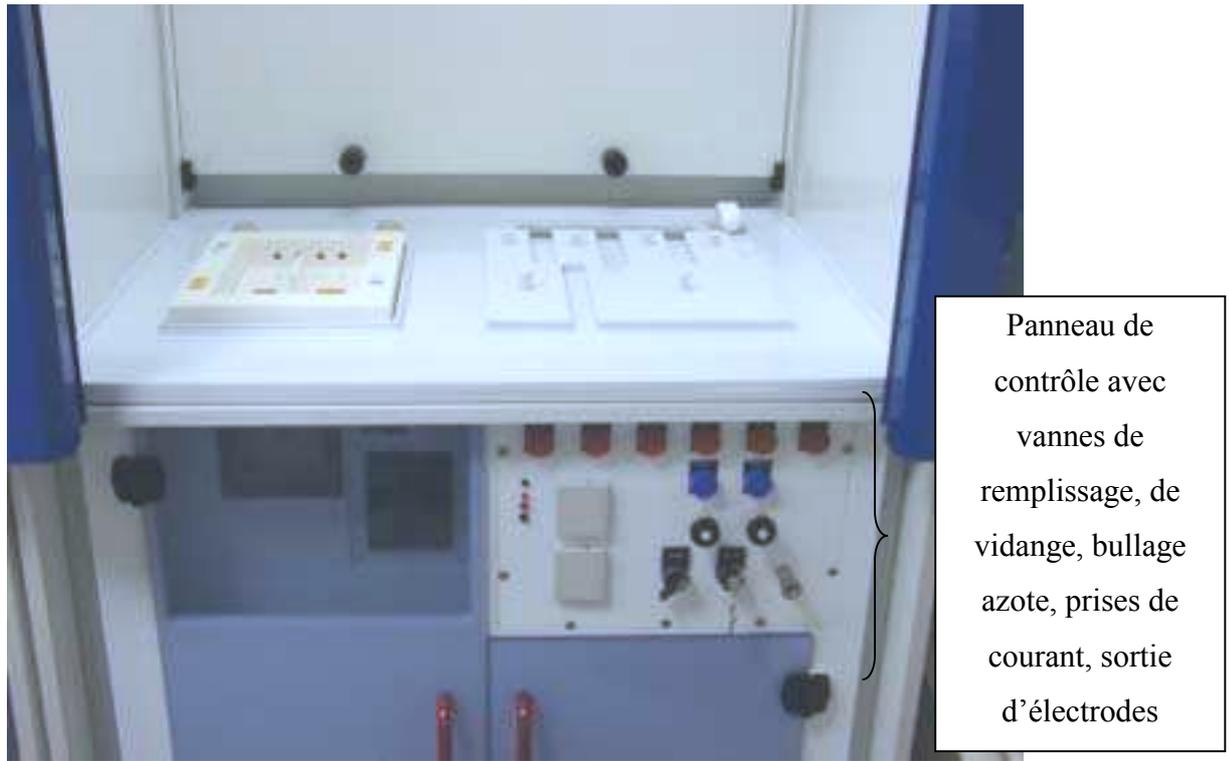
*Figure 2* : vue de dessus et vue du panneau avant du stand d'acidage
