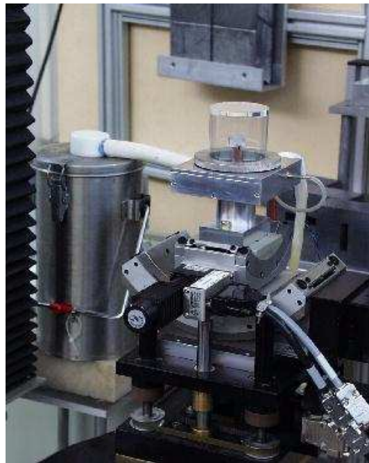
FIG. 2.9 – Cellule de refroidissement dans laquelle est placé l'échantillon. La cellule est posée sur une table goniométrique. On aperçoit le réservoir d'azote liquide sur la gauche, ainsi que la position de l'échantillon dans la cellule.
