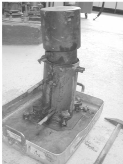
Figure 6-17 : Filtration de la barbotine par une technique du type filtre/presse
