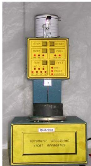
Figure 6-18 : Détermination du temps de début au moyen de l'essai Vicat
