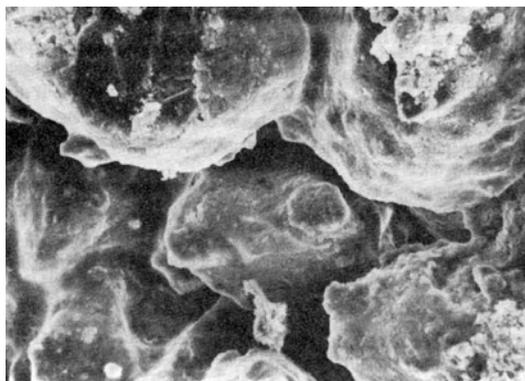
Figure 2-9 : Microstructure d'un sable traité au ciment puis compacté <sup>[25]</sup>
