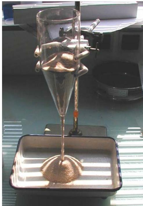
Figure 6-7 : Essai d'écoulement d'une poudre 100-500  $\mu\text{m}$
