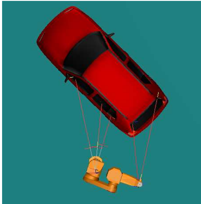
FIG. 4.23 – La prise de mesures en utilisant un capteur laser.
