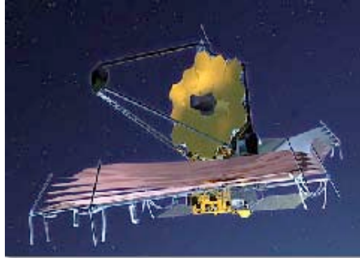
Fig. 6.1: Vue d'artiste du futur James Webb Space Telescope, de 6.5 mètres de diamètre. Un gigantesque pare-soleil protège son miroir et lui permet d'abaisser sa température aux 240 Kelvins nécessaires pour fonctionner dans le domaine proche-infrarouge.
