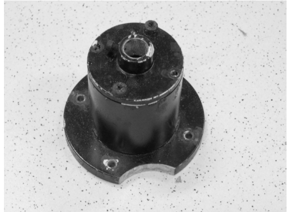
Piège à lumière situé en fin de chemin optique du faisceau laser, à l'intérieur de la chambre.
