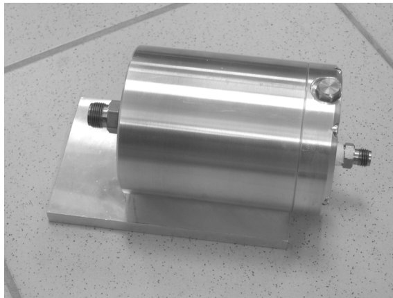
Ensemenceur de particules liquides.
