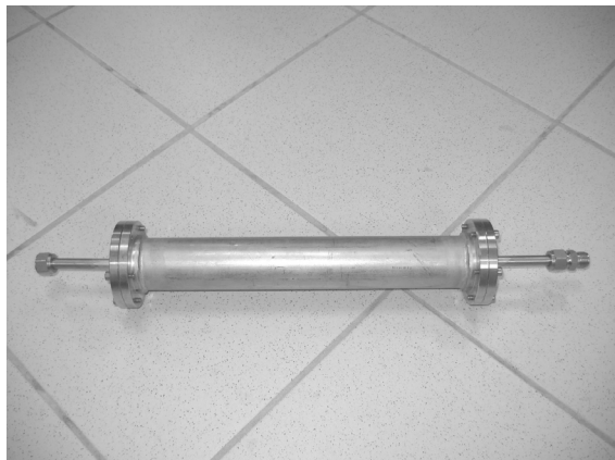
Assécheur d'air se positionnant avant le lit fluidisé et contenant du chlorure de calcium.
