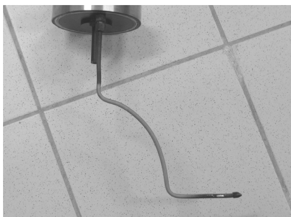
Tube permettant la ventilation du hublot par un balayage d'azote évitant la condensation des produits de combustion.
