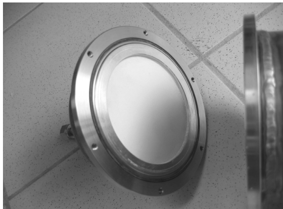
Fritté en verre créant le lit fluidisé lors du passage de l'air pour l'ensemencement de particules solides (oxyde de zirconium) 0.9 MPa (absolu) maximum.
