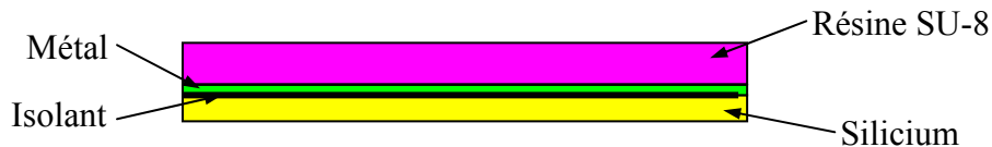
Figure 3.31 : schéma du micro-actionneur thermique SU-8 sur silicium
