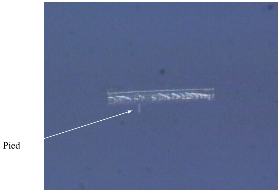
Figure 3.61 : photo d'une micropatte vue en bout avec son pied en résine SU-8 (premier essai de dépôt du pied)
