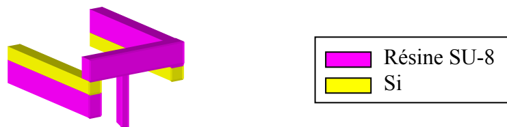
Figure 4.10 : Schéma de la micropatte en résine SU-8 sur silicium avec une liaison SU-8 de 60 \mu\text{m}
