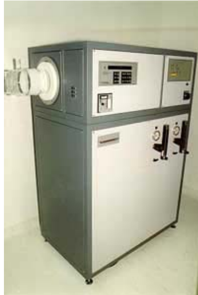
Figure 4.2: Four d'oxydation thermique (salle blanche du CTM)
