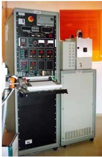
Figure 4.6 : Bâti deRIE à gaz fluoré Plassys (salle blanche de l'IMFC)
