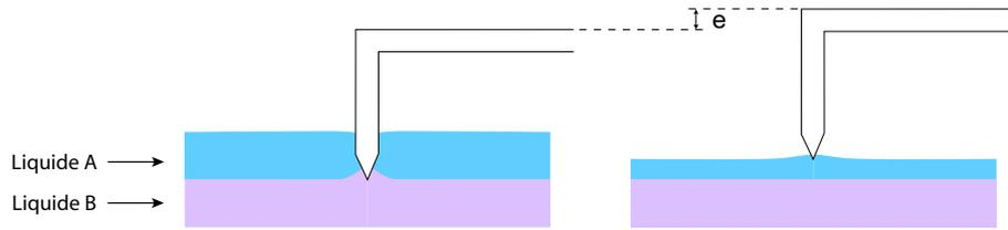
FIG. V.2 – Mesure de l'épaisseur avec la tige initiant le démoillage. i) On mesure la hauteur de l'interface A/B pour une épaisseur de A proche de  $e_c$ . ii) On retire le volume d'eau voulu puis on mesure la hauteur de l'interface A/Air. On en déduit par différence l'épaisseur  $e$ .
