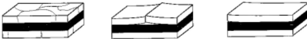
Figure I-6 : Types de défauts principaux générés lors du frittage contraint : fissuration, délaminage et décohésion [16].
