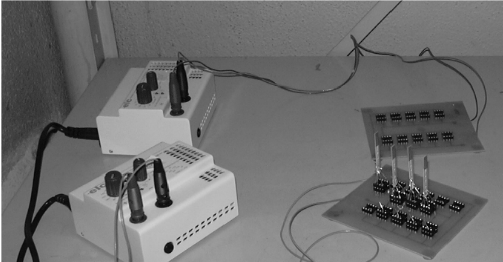
Figure 50 Photo du montage de vieillissement des capteurs.
