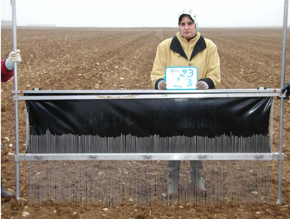
Figure 8 : Profil de rugosité réalisé par un profilomètre à aiguilles dans la direction parallèle aux sillons sur le site de Villamblain.
